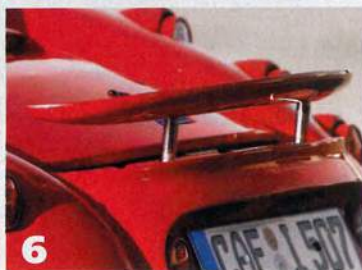
1 Schwarzes Nappa-Leder mit roten Einsätzen und Steppmuster „Raute“, analoge Rundinstrumente im Wiesmann-Cockpit 2 Zehnzylinder-V-Motor aus dem BMW M5 mit 507 PS und 520 Nm maximalem Drehmoment 3 19-Zoll-BBS-Räder, Michelin Pilot Sport Cup und Brembo-Bremsanlage 4 Gut passende Sportsitze 5 Zweiflutige Abgasanlage mit herzhaftem Bariton 6 Der Heckflügel fährt ab 150 km/h automatisch oder auf Knopfdruck aus
