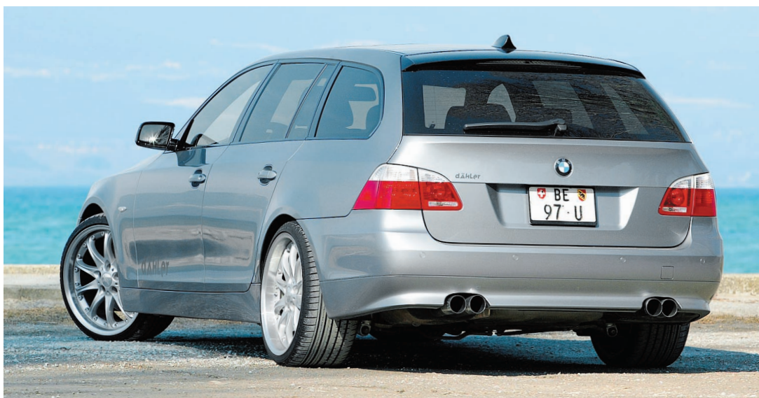
Die vierflutige Abgasanlage (Ø je 76 mm) ist eine Eigenentwicklung. Mächtig: die Hartge-Räder in 20 Zoll.
