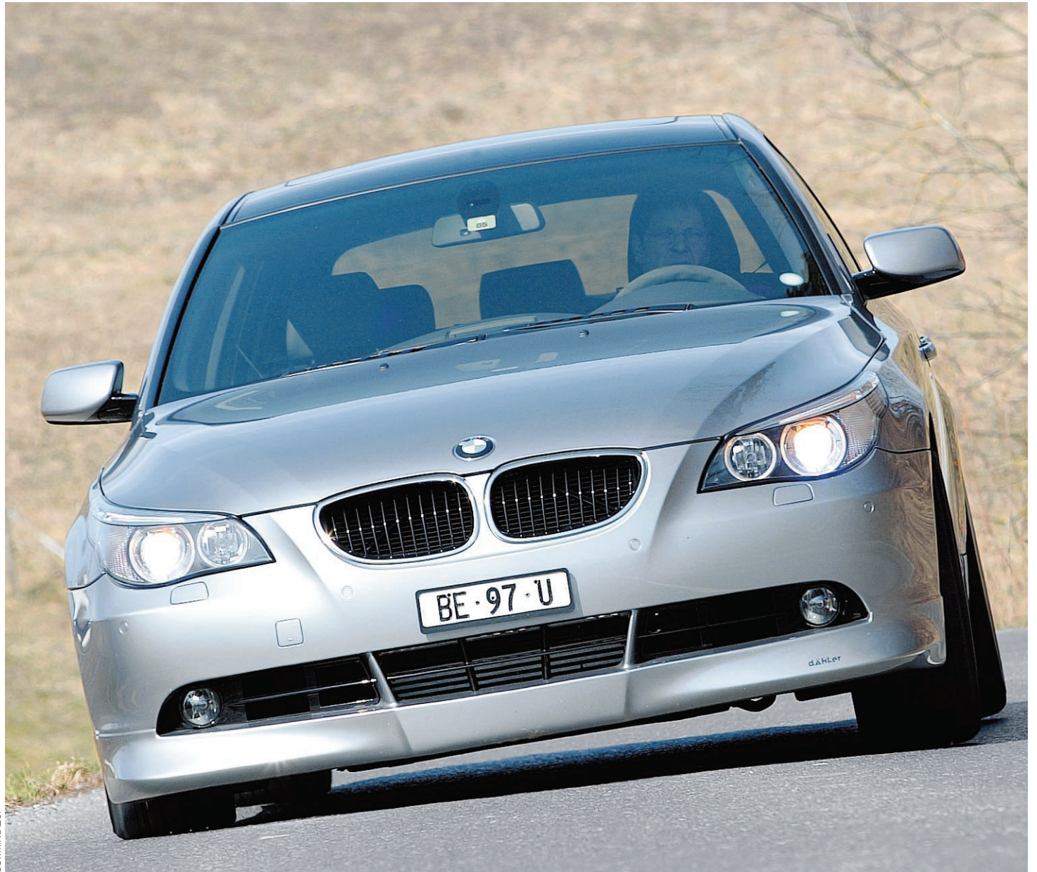
Wuchtbrumme mit 310 PS und 630 Nm. Das Gewindefahrwerk spricht feinfühlig an und ist trotz der kurzen Federwege komfortabel.
