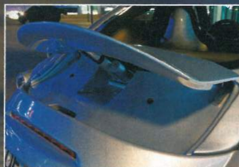
Minimierung des Auftriebs: Der Flügel fährt auf Knopfdruck oder automatisch bei Tempo 120 aus
