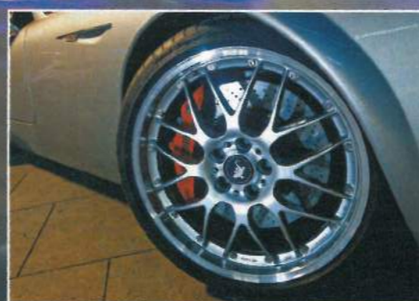
Sechskolben-Bremsanlage mit 380er-Brems-scheiben vorn, 20-Zoll-Leichtmetallräder von BBS
