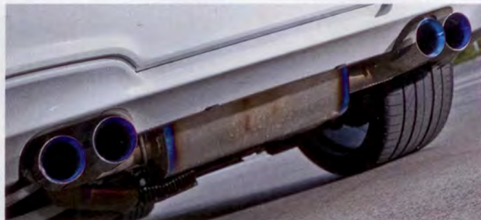
Den Titanauspuff lässt Dähler in Kleinserie fertigen. Die strengen Richtlinien in seiner Heimat zwingen den Schweizer zu einer dezenteren Stimmlage
