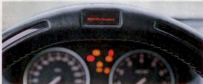
Das Performance-Lenkrad mit Schaltpunktanzeige, Stoppuhr und allerlei weiteren Spielereien stammt aus dem BMW-Performance-Programm
