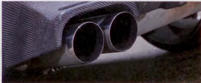
Am Heck des MH1 entweichen die Abgase über ein vierflütiges System mit Sportkat. Manhart schraubt es unter den hauseigenen Karbondiffusor
