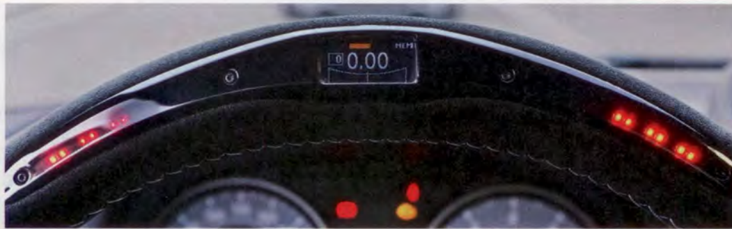
Auch an der deutsch-niederländischen Grenze setzt man auf das LED-bestückte BMW-Performance-Sportlenkrad, von dem sich Rundenzeiten, Fliehkräfte sowie Öl- und Wassertemperatur ablesen lassen
