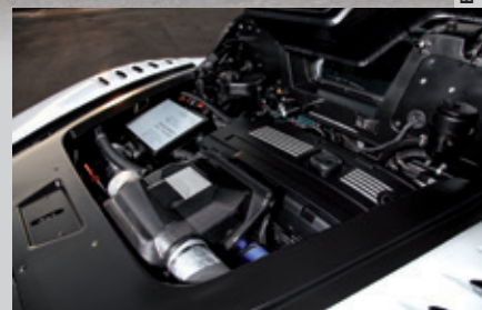
Statt 320 PS wie in der Serie leistet der 3-Liter-Turbo im Roding R1 von Dähler satte 450 PS.
